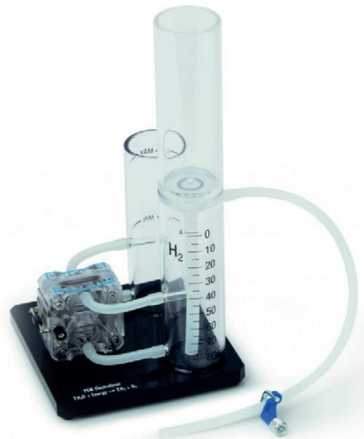
**Elektrolyseur mit H<sub>2</sub>-Speicherfunktion**
