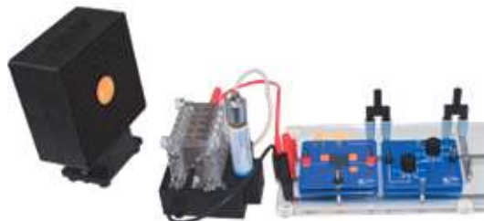
Anwendungsversuch II Untersuchung der Brennstoffzellenleistung in Abhängigkeit der Luft-Sauerstoffversorgung
