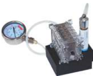
Anwendungsversuch I Umgang mit Wasserstoff-Druck-Systemen (Dichtigkeitstest)
