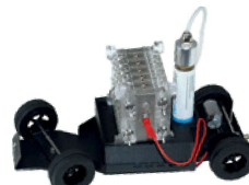
Anwendungsversuch II Elektrischer Antrieb mit Druck- speichersystem
