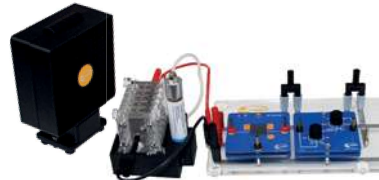
Anwendungsversuch I Untersuchung der Brennstoffzellenleistung in Abhängigkeit der Luft-Sauerstoffversorgung
